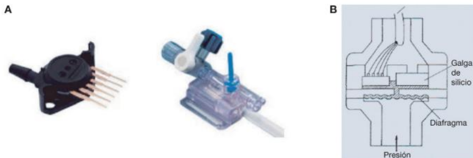
FIGURA 6-3 Transductores de presión. A. Ejemplos de transductores de presión. B. Diagrama de funcionamiento de un transductor de presión. (Por cortesía de Edwards Lifesciences LLC.)
